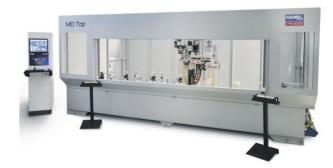
Los centros de trabajo de la serie MD han desarrollado un nivel tecnológico adaptado a la industria 4.0, que permite la automatización de los pedidos y la ejecución de múltiples operaciones en un único ciclo de trabajo: taladrado, escopleado, fresado, tronzado, espigado, contorneado/ perfilado... Todas ellas presentes en una misma pieza.
